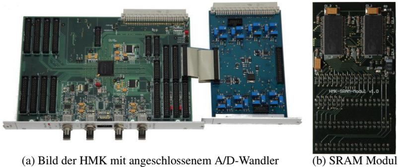
Abbildung 5.6: Fotografie der HMK mit angeschlossenem A/D-Wandler sowie des aufsteckbaren SRAM-Moduls.
