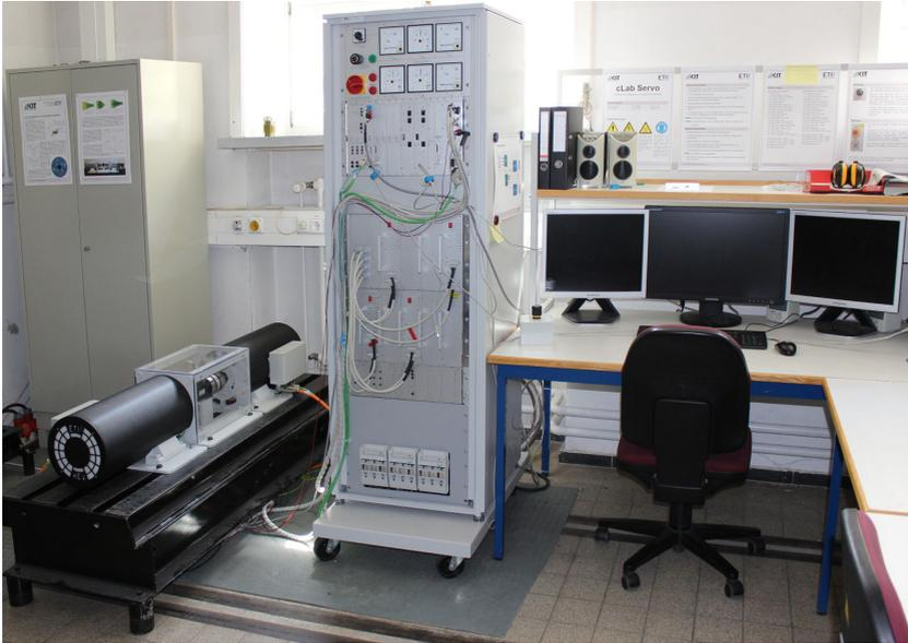
Abbildung 5.4: Eingesetzter Prüfstand bestehend aus Maschinensatz (links), Umrichter-schrank (Mitte) und PC als Benutzerschnittstelle (rechts)
