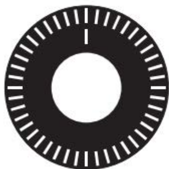
Abbildung 30: Coderad eines Inkrementalgebers [15]
