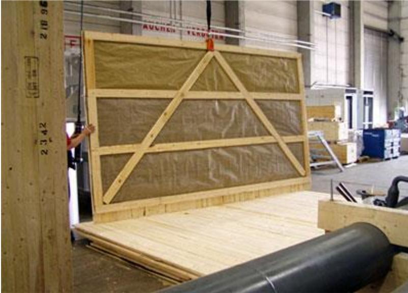
Abbildung 7: Seitenwand mit Sperrschicht ausgekleidet
